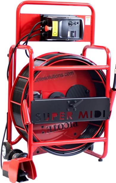
Le Super Midi Miller est conçu pour le nettoyage, le détartrage, l'élimination des racines, et la coupe/réhabilitation des canalisations DN70-150. Il bénéficie d'une portée de 20m qui peut être augmentée de 10m avec une rallonge. Il peut également être associé à la Maxi Pompe Picote pour la projection de résine dans les canalisations DN70-200.
