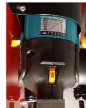
Le réglage de vitesse se trouve sur le moteur
