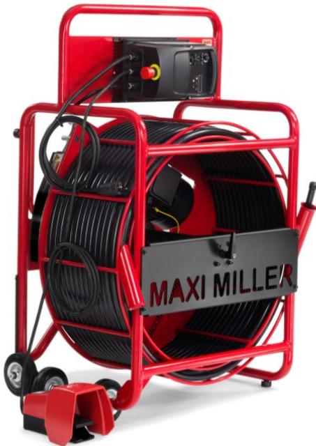
Le Maxi Miller est une unité portative électrique à grande vitesse et à couple élevé conçue pour le nettoyage, le détartrage et l'élimination des racines dans les canalisations de DN70-250 et la réouverture/réhabilitation dans les diamètres DN70-200.
