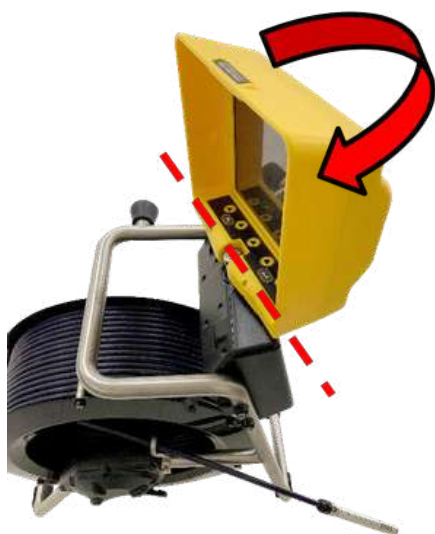
Le côté ouvert du frein et du déploiement de la canne
