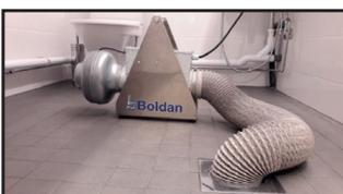
Pour accélérer le processus et sécher le tuyau, utilisez Sewer Dryer.
