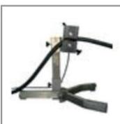
Le « tire-câble » électrique assure la linéarité parfaite du déplacement de la buse de pulvérisation, en fonction de l'épaisseur de résine voulue.
