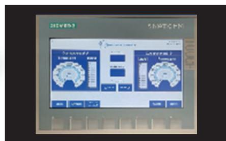
Toutes les phases de la réhabilitation sont contrôlées par un automate, qui analyse en temps réel l'ensemble des informations. Une interface tactile permet d'ajuster les différents paramètres réglables.
